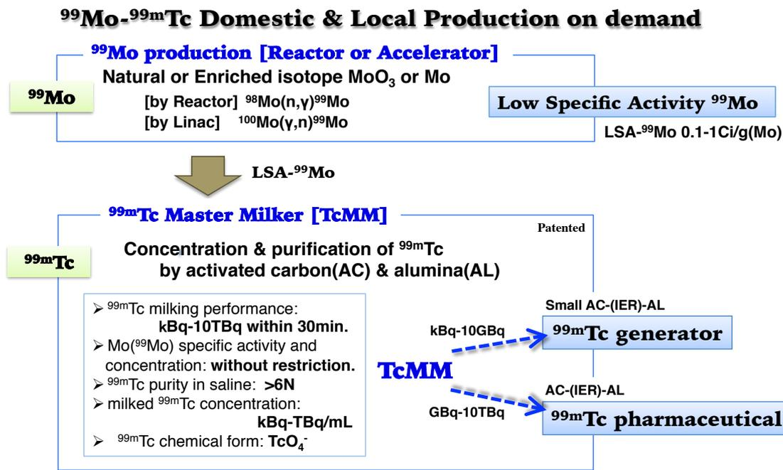
**Fig. 5 Kaken <sup>99</sup>Mo-<sup>99m</sup>Tc Process**
